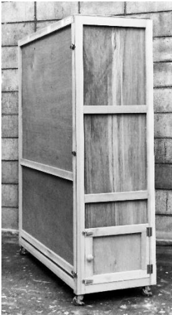
製版機(学生時代に作成し現在も使用) 乳剤を塗布した版の乾燥・保管用ボックス
