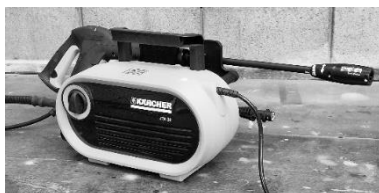
水洗現像に使用している高圧洗浄機(ケルヒャー)とノズル(バリオスプレーランス)
