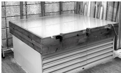
製版機(学生時代に作成し現在も使用) 乳剤を塗布した版の乾燥・保管用ボックス
